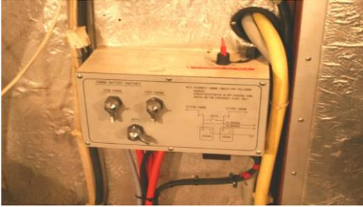
Wenn ein Motor nicht gestartet werden kann, da die Batterie leer ist, so können im Motorraum steuerbordseitig (Bild) direkt beim Eingang durch Betätigen des Umschalters beide Batterien zusammengeschlossen werden, d.h. in diesem Fall kann die zu schwache Batterie überbrückt werden.
