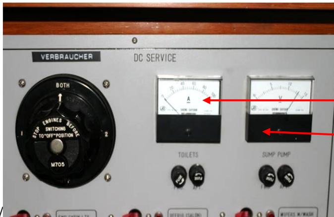
Am Elektropanel oben befindet sich der **12 Volt Batterieumschalter**, der **jedoch immer in der Stellung „both“ bleiben muß**, damit Strom aus beiden Service- batterie entnommen wird.
