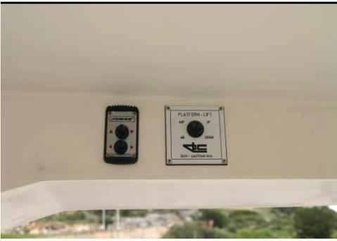
Die hydraulische Badeplattform und die hydraulische Gangway kann entweder mit der jeweiligen Fernbedienung oder mit den steuerbordseitig oben in der Plicht eingebauten Bedienelementen bedient werden.
