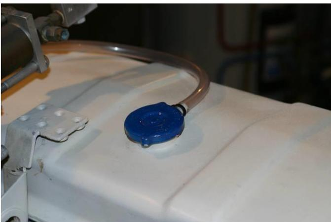
Die **Motorölkontrollstäbe** für beide Maschinen befinden sich in der Mitte, das heißt der Messstab der Backbordmaschine befindet sich steuerbordseitig und der Messstab der Steuerbordmaschine befindet sich backbordseitig.
