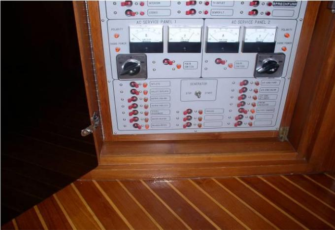
Sämtliche Schalter und Sicherungen des 220 Volt System Voltssystem befinden sich im Salon unter dem Sitz beim Steuerstand (die unteren Sicherungen), dort befinden sich auch der Starter für den Generator sowie die 220 Volt Hauptsicherung. Auch hier gilt, dass die Schalter eine doppelte Funktion haben, nämlich einerseits zum Einschalten der einzelnen Stromkreise und andererseits als Sicherung für diesen Stromkreis.
