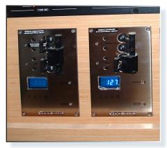
AUXILIARY BATTERIES CHARGE STATUS CHECK SCREEN
